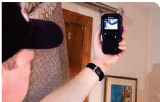
FLIR MR160 skanner tak- og veggskjøter på jakt etter fuktighetsproblemer.
